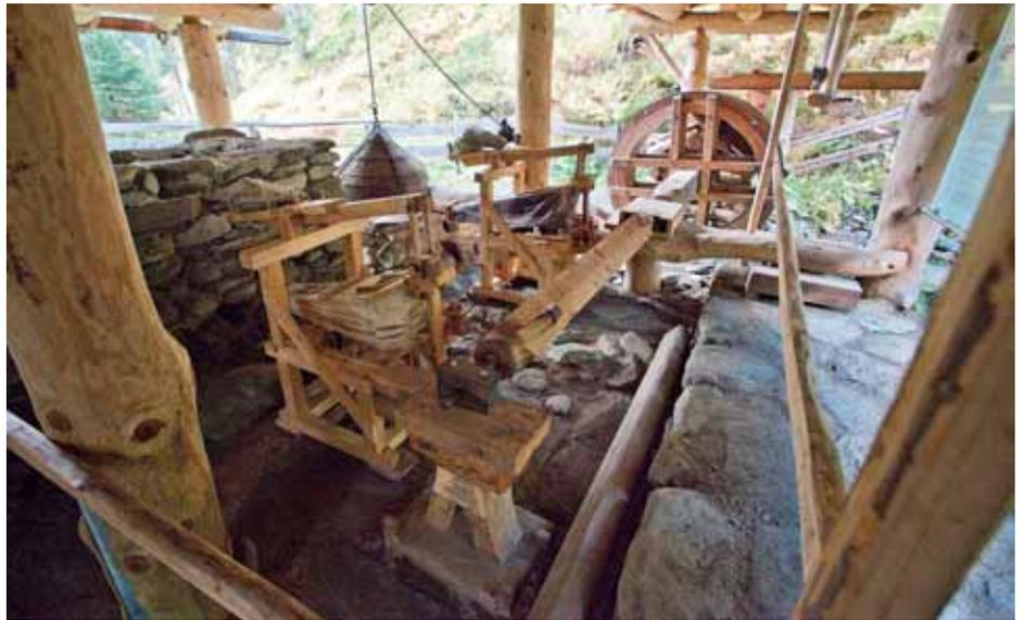
Rekonstruktion eines Hüttenwerks im Angertal bei Bad Gastein, im Hintergrund das Wasserrad eines Pochwerks. In dieser Region im Salzburger Land waren die Augsburger Fugger erstmals am Bergbau beteiligt. Aus dem Bergwesen kamen wesentliche Innovationen für die Wasserhebung und Wasserkraftnutzung in den Städten. Foto: Martin Kluger
